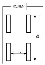
контроль размеров проезда с помощью шаблона. Высота брусков составляет 80 мм.
